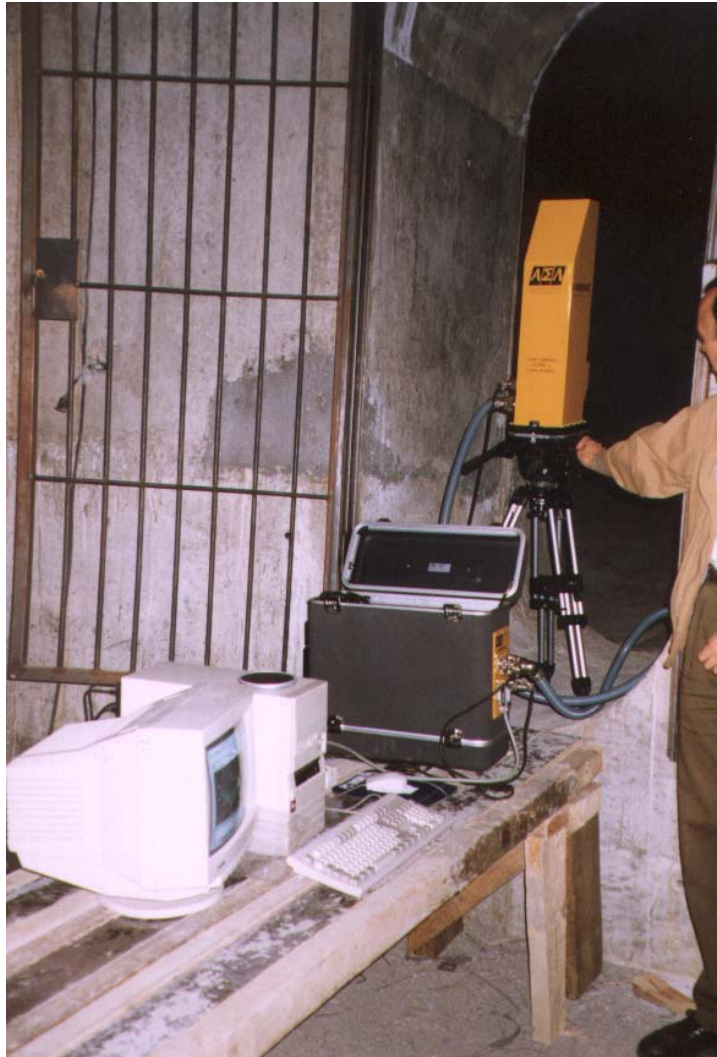
Figura 9. Equipo láser utilizado en la prueba de carga
