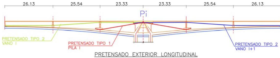
Figura 15. Pretensado exterior longitudinal. Alzado, familias tipo 1 y 2
