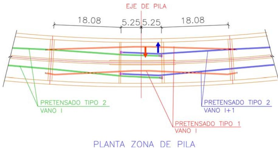
Figura 18. Planta asimétrica del pretensado exterior longitudinal
