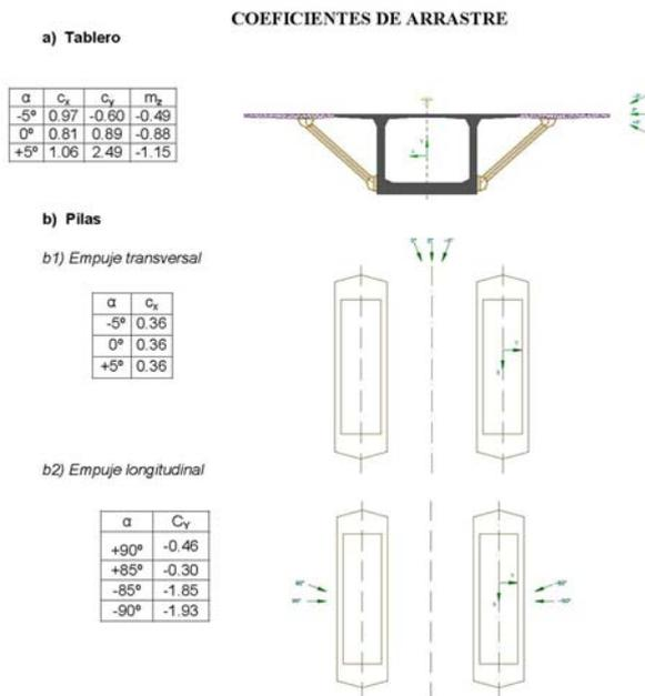
Figura 9. Coeficientes de arrastre en tablero y pilas
