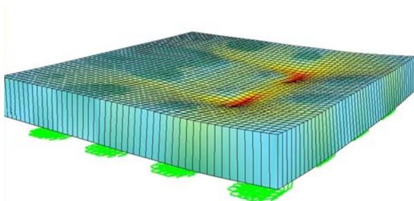
Figura 12. Modelo elementos finitos del encepado de P3 y P4
