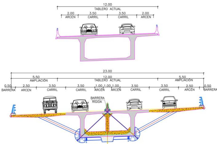
Figura 1. Secciones transversales. Viaducto original y ampliado
