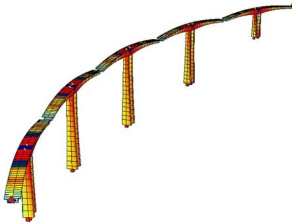
Figura 14. Modelo evolutivo para el cálculo general de viaducto
