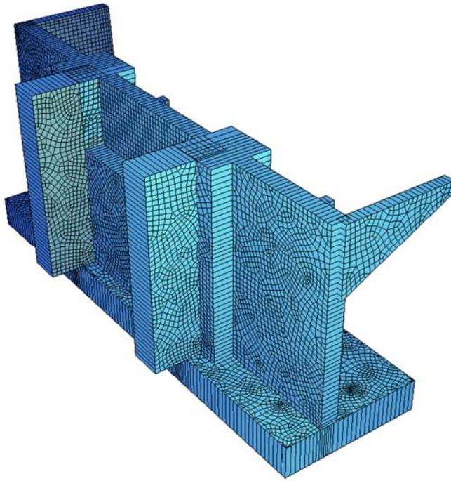
Figura 13. Modelo elementos finitos para el cálculo del estribo
