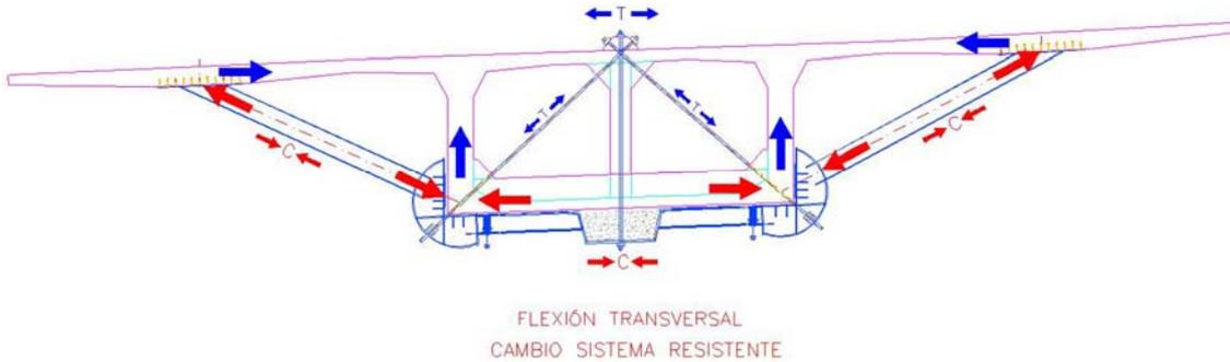
Figura 20. Mecanismo resistente de la flexión transversal
