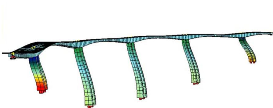
Figura 10. Modelo de cálculo de subestructura
