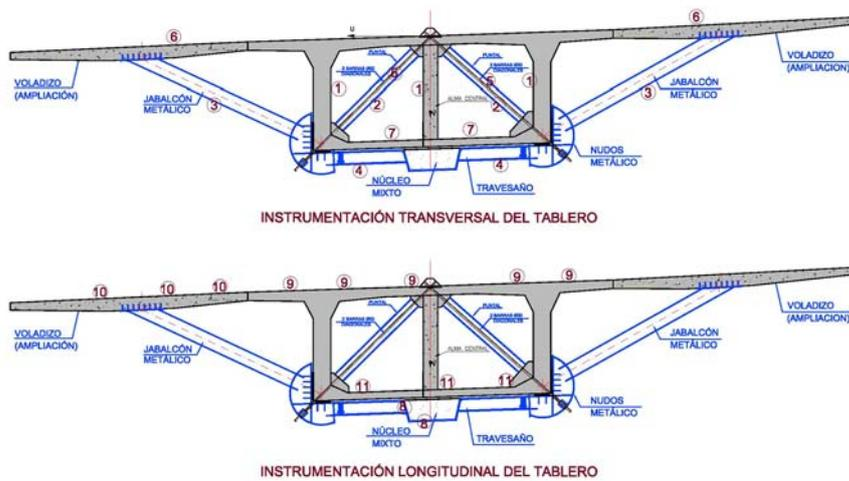
Figura 42. Instrumentación dispuesta en el tablero (los números indican la designación de cada banda extensométrica)
