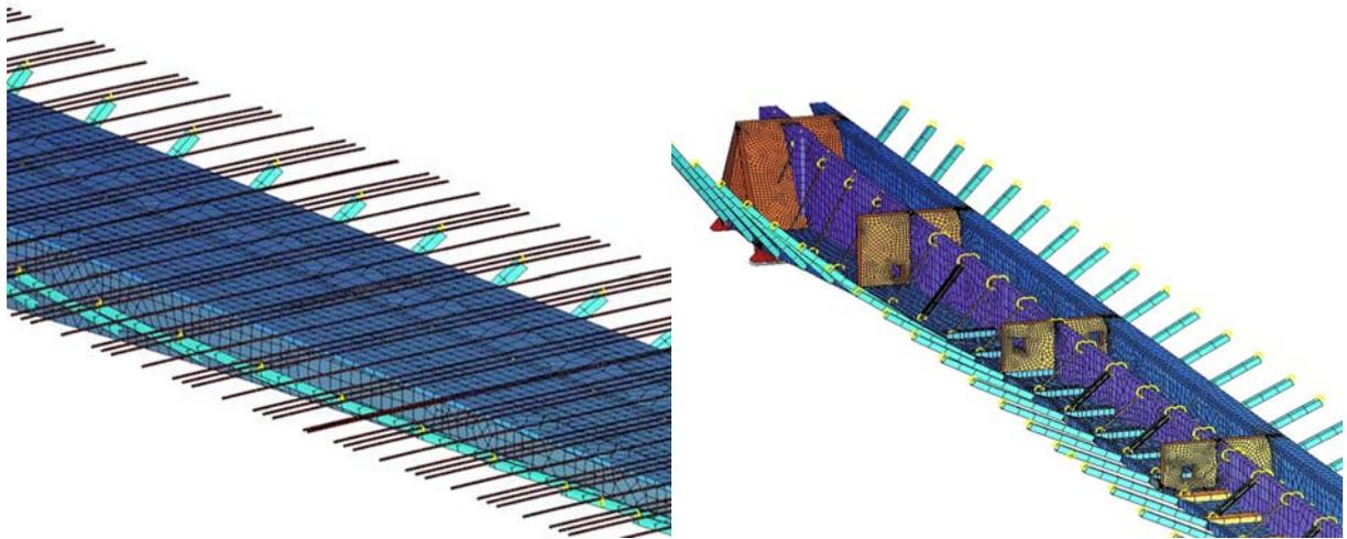
Figuras 22 y 23. Modelo elementos finitos. Cálculo transversal
