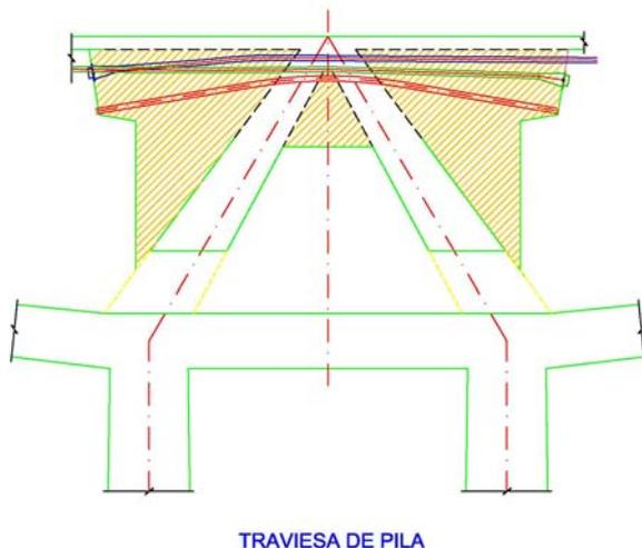
Figura 24. Macizado zona superior de la traviesa de pila
