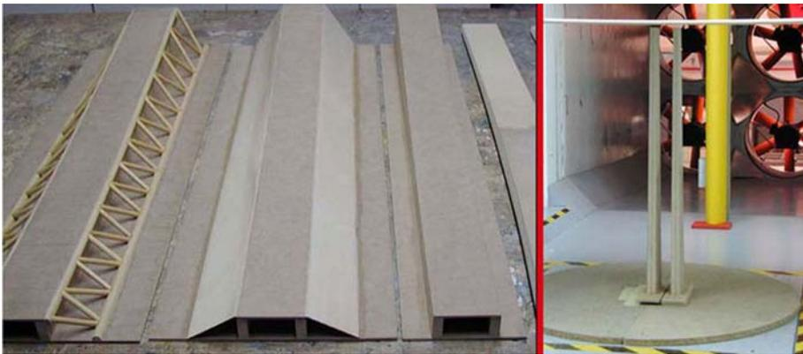
Figura 8. Modelos reducidos para ensayo en túnel de viento
