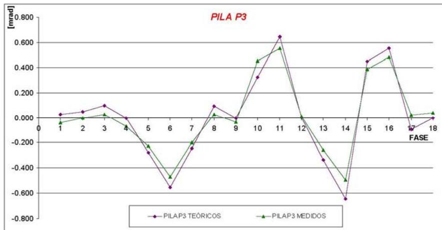
Figura 43. Giros medidos y calculados en la pila P3 durante la prueba de carga
