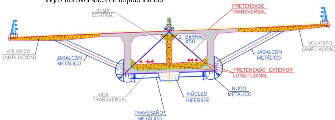
Figura 6. Solución de refuerzo de cajón existente. Principales elementos
