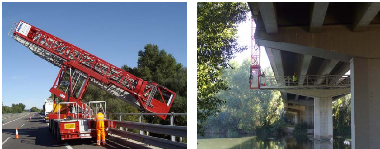
Figura 10 – Vistas de la pasarela autoportante utilizada en buena parte de las inspecciones
