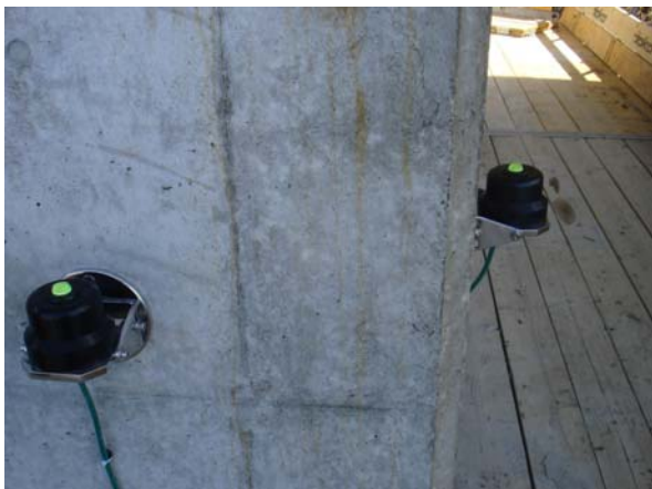
Figura 7. Detalle de los clinómetros, longitudinal y transversal, instalados en la cabeza de cada pila.
