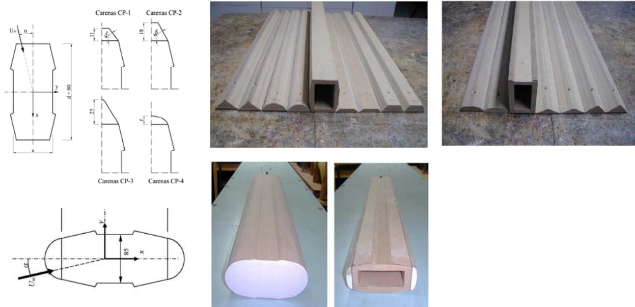
Figura 8. Carenados ensayados para pilas y arco
